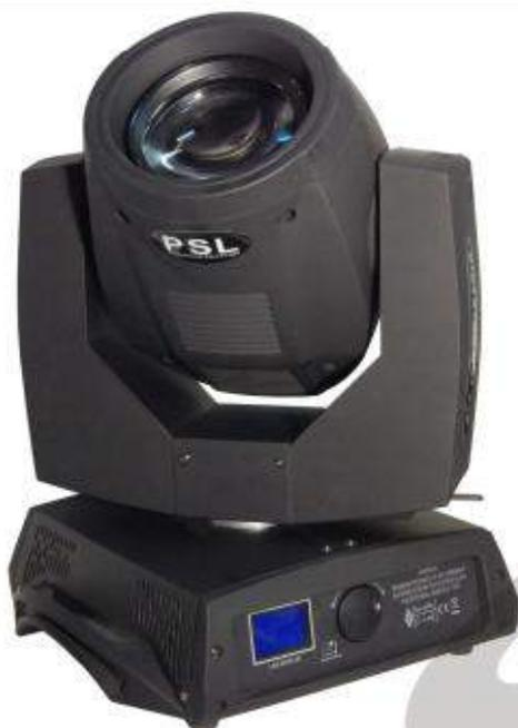
Dictator-Ray Plus 7R specificatamente progettato per la lampada Osram 7R, eroga un coerente e potente fascio luminoso (100.000 Lumen) con angolo di 4° in veloce e silenzioso movimento. Offre 14 colori più il bianco, 17 gobos e un prisma a più facce che consente di modificare la forma del fascio e creare una serie di spettacolari effetti. Controllabile con 16 canali del segnale digitale DMX 512 a 8/16 bit per una precisa e fluida scansione nei movimenti.
