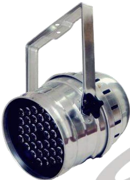
Proiettore in alluminio brillantato Par 64 con sorgente LED composta da 6 rossi, 12 verdi, 12 blu e 6 bianchi, con angolo del fascio luminoso di 20°, perfetto per essere utilizzato come cambia colori. Possibilità di regolazione dell'intensità luminosa agendo direttamente sul pannello posto sul retro del proiettore o con un segnale digitale DMX 512. Il basso consumo di esercizio, solo 140W, consente di utilizzarlo in grande
