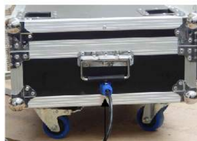
COLLEGAMENTO ALLA RETE ELETTRICA
